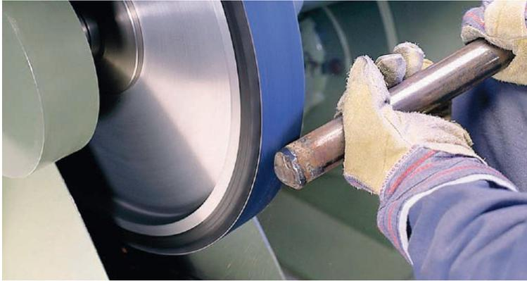
Los rollos abrasivos de SIA, se dividen en 3 categorías: madera, metal y automotriz. A su vez, se dividen en abrasivos flexibles, no tejidos y gomaespuma. Los discos se adhieren a las herramientas eléctricas o mecánicas de lijado, y usan granos de corindón, circonio y diamante para asegurar la resistencia y calidad del trabajo.
