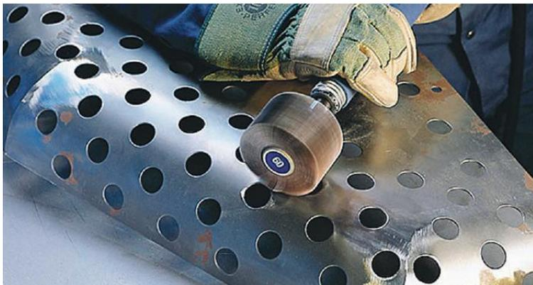
Las ruedas abrasivas de SIA, se dividen en 3 categorías: madera, metal y automotriz. A su vez, se dividen en abrasivos flexibles, no tejidos y gomaespuma. Las ruedas o cepillos SIA, son para el satinado de metales y para el rectificación de soldaduras y acabado general del acero al carbono e inoxidable. Desde grano grueso a muy fino.
