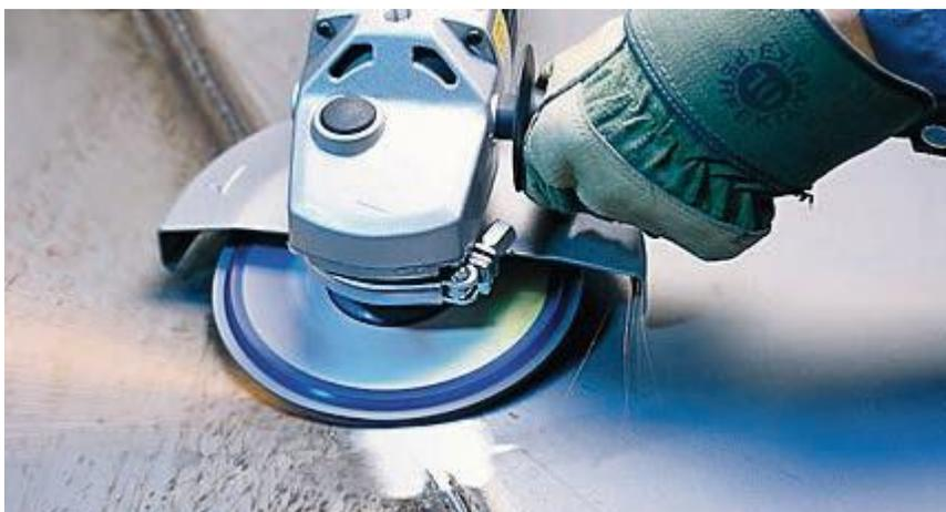
Los discos abrasivos de SIA, se dividen en 3 categorías: madera, metal y automotriz. A su vez, se dividen en abrasivos flexibles, no tejidos y gomaespuma. Los discos se adhieren a las herramientas eléctricas o mecánicas de lijado, y usan granos de corindón, circonio y diamante para asegurar la resistencia y calidad del trabajo.
