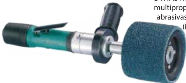
DYNASTRAIGHT incluye el componente multipropósito 13061 Arbor para montar ruedas abrasivas opcionales de 1/2" a 3" de ancho (incrementos de 1/2") con orificios centrales de 5/8" o 1". Con la potencia de .4 hp, logra acabados suaves en acero inoxidable y componentes utilizados en industrias de cocinas y baños.
