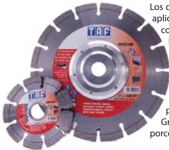
Los discos de diamante TAF son idóneos para aplicaciones de corte sobre materiales de construcción, piedras naturales y plásticos. Fabricados con una alma de acero interno y de una parte externa que puede ser un segmento o una corona continua. Corta rápidamente y con plena seguridad. La Serie Marmol no debe ser usada sobre ladrillo, cemento y granito pues se puede dañar gravemente el disco. El Serie Gres Porcelánico es apto para cortar gres porcelánico, azulejos y cerámica.
