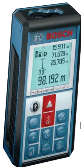
Nuevo Telémetro Láser GLM 100 C: el más compacto del mercado: cabe en su bolsillo. Único telémetro láser con certificación ISO: mediciones precisas hasta 30 m de distancia. Función de suma automática: facilita cálculos y presupuestos. Pantalla con sensor automático de iluminación. Protección IP 54 contra polvo y salpicaduras de agua. Un solo botón realiza todas las operaciones, gracias al concepto innovador patentado por Bosch.
