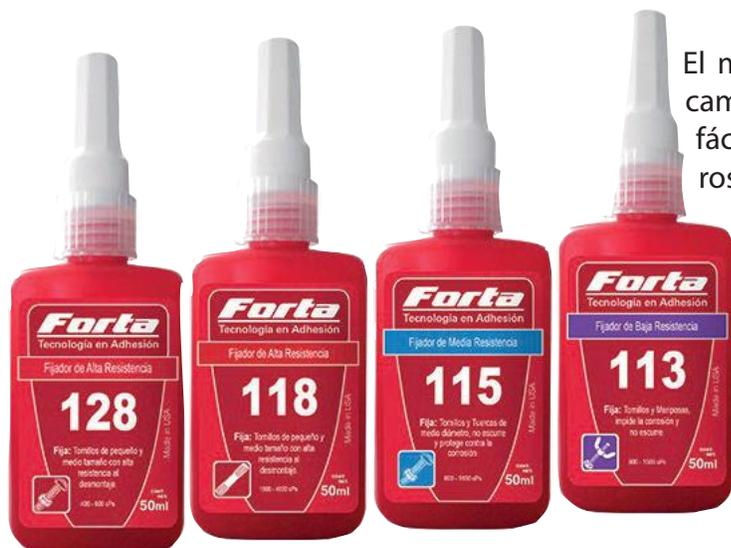
El modelo Forta 113 es de baja resistencia, cambia la viscosidad al tacto, desmonta fácilmente, aplicación principalmente en roscas con un diámetro de M2-M14. El modelo 115, es para resistencia baja a mediana, y se aplica en tuercas M6-M20. La resistencia va aumentando dependiendo del número de modelo hasta el fijador Forja 128, ideado para montaje permanente.
