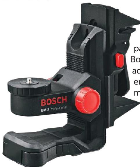
El soporte universal BM 1, es un soporte con exclusivo clip para fijación en el techo: ideal para las aplicaciones de rebajamiento de techo. Botón con dos posiciones de fijación. Apoyo adicional para pared. Imán para rápida fijación en bases magnéticas. Base de apoyo retráctil: más estabilidad para aplicaciones en el suelo. Presilla para carril-guía. Base giratoria y botón de ajuste fino.
