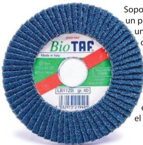
Soporte innovador patentado, que consiste en un paquete de cartón fibrado biodegradable, unido en caliente a una red de fibra de vidrio que proporciona una gran resistencia en la fase de esmerilado. Producto diferenciador con un excelente precio. Apto para el desbaste universal en acero carbono y hierro en presiones de trabajo moderadas. Biotaf puede usarse en aplicaciones pesadas si le proveemos el plato de soporte con código PBI067.
