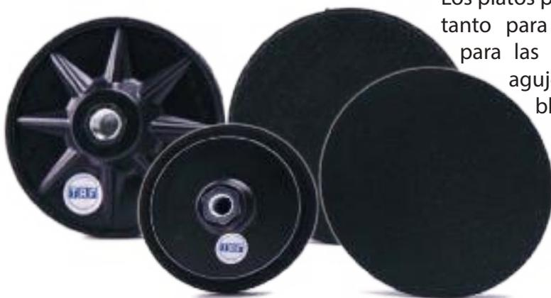
Los platos para discos velcrados, tienen modelos tanto para las lijadoras roto-orbitales, como para las rotativas, en distintos diámetros y agujeros de filtrado de aire. Los soportes blandos para discos de velcro de las lijadoras rotativas son útiles con acabados y lijados que requieren mayor flexibilidad del disco. Hay adaptadores tanto para taladradora como para roto-orbital.
