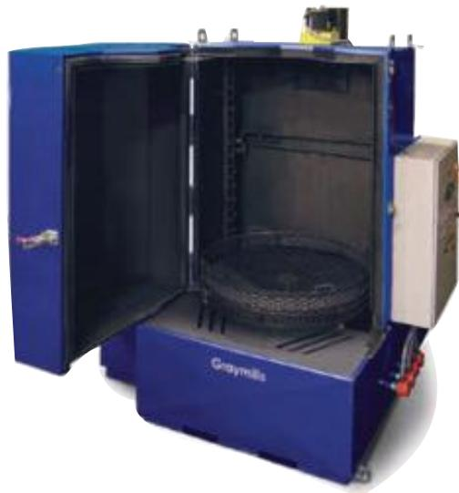
La limpieza rápida y efectiva se logra mediante un poderoso rocío de solución de limpieza calentada a base de agua. La combinación de presión y volumen de pulverización elimina los depósitos más difíciles sin dañar las piezas de precisión.
