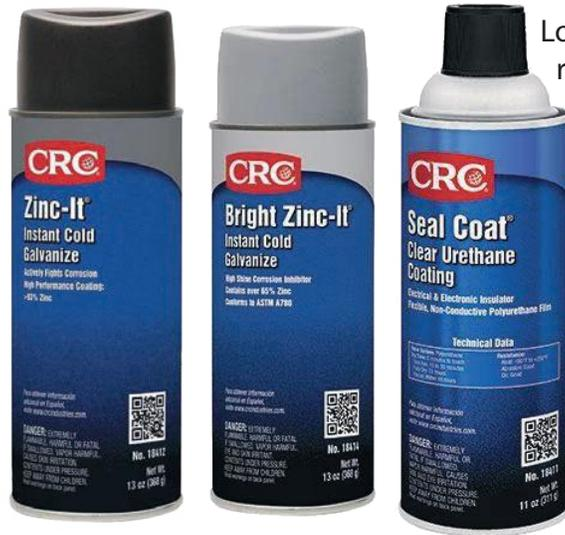
Los modelos Zinc-It, proporcionan recubrimiento de alto rendimiento mayor al 93% de zinc puro que se une electroquímicamente con metales ferrosos para formar una celda galvánica. Combate activamente el óxido y la corrosión con todos nuestros modelos. Úsalos como retoque para recubrimientos galvanizados dañados. Se secan rápidamente. Protección exterior: 1-2 años.
