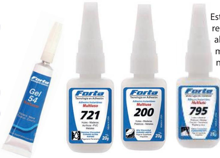
Estos productos están especialmente recomendados para adhesiones que requieren alta velocidad de curado. Es un producto mono componente basado en cianoacrilato y no requiere de mezcla. El proceso de curación comienza cuando el adhesivo entra en contacto con la humedad. Puede ser utilizado en los materiales que requieren llenar los vacíos, pegar caucho, plástico, metales y otros sustratos. Adecuado para los componentes electrónicos.
