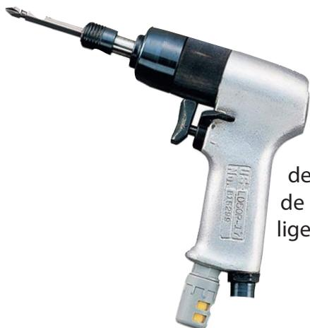
Diseñados para aplicaciones de juntas blandas, como tornillos de madera, autorroscantes, tornillos de ajuste del vehículo u otros materiales que no requieren control de par crítico. No contienen embrague, lo que hace que el motor neumático se detenga cuando la resistencia de torque es mayor que la salida de torque de la herramienta. Herramientas muy pequeñas y ligeras para facilitar su uso durante todo el día.
