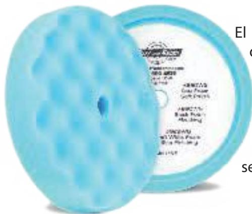
El soporte RECESSED protege superficies de las orillas de los soportes de plato. Dependiendo del trabajo se puede optar por una cara compleja o plana. Las caras con forma de cascarón de huevo mejoran la circulación del aire para trabajos de pulido más suaves y fríos, y mejorar la seguridad.
